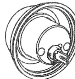
Enclencher la contre-tige en position horizontale et tourner 90 degrés à la position verticale.
