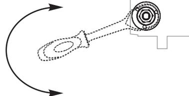
Diminuer la force du ressort dans le sens contraire des aiguilles d'une montre
