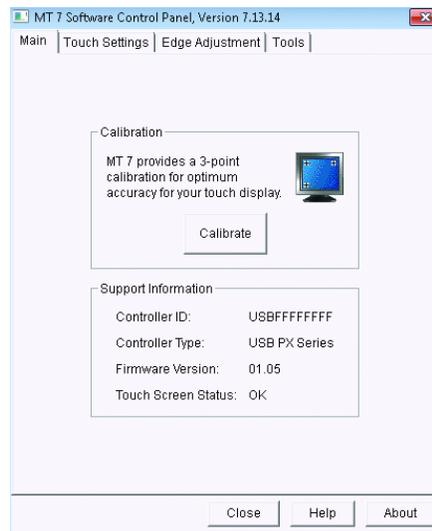
**Figure 113. Logiciel MT 7 de panneau de contrôle**
