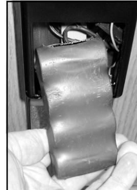
FIG. 18: INSERT BATTERY PACK INTO HOUSING
